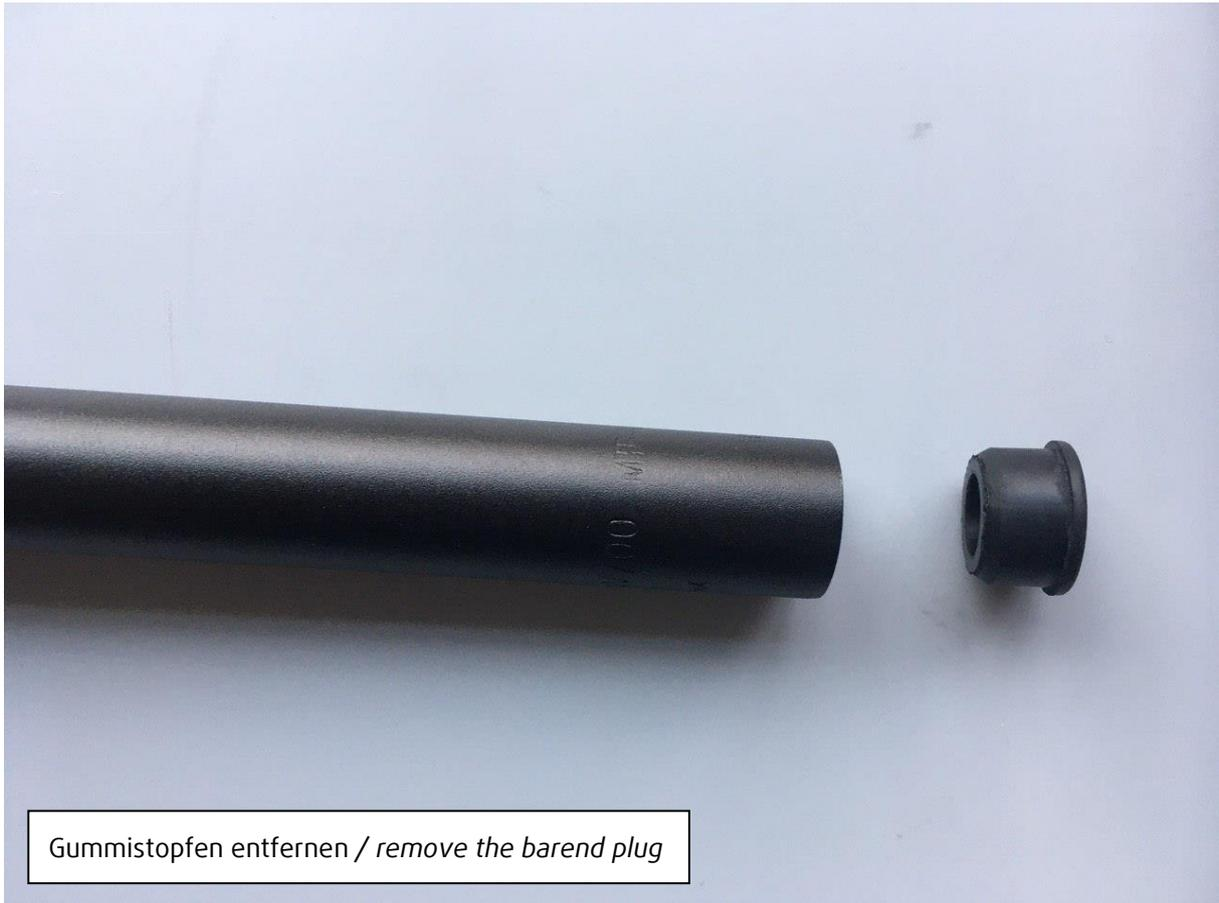
Gummistopfen entfernen / *remove the barend plug*
