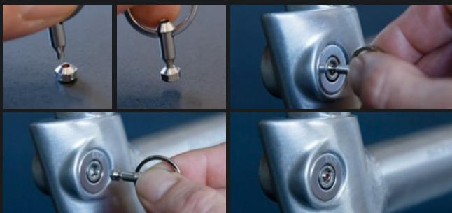
Hexlox funktioniert nur an magnetischen Stahlschrauben, weshalb an unseren Modellen die Edelstahl-Inbusschrauben ersetzt werden müssen. Diese sind im Lieferumfang enthalten.
